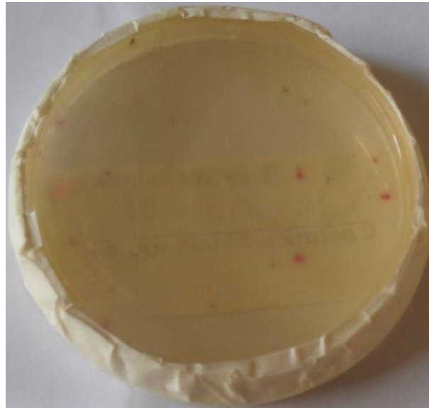
Figura 19.- Coliformes fecales presentes en la captación de agua El Remolino Fuente: Equipo Consultor
